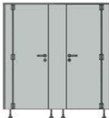
Bei Türen, die nach außen öffnen, sind die Bänder und das Klemmschutzprofil auf der Fläche sichtbar.
