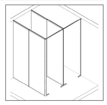
Nun wird das U-Profil glatt (30/17/30) auf den SPM geschraubt. Dieses Profil hat die gleiche Länge wie die Spiegelteile und muß nicht zugeschnitten werden.
